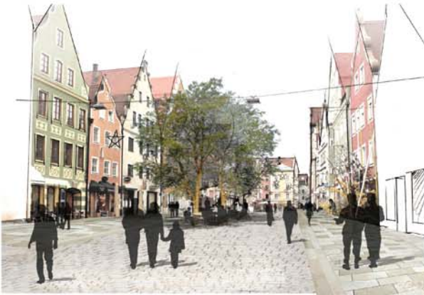
Ein insgesamt bodenbündiges Belagssystem spannt sich zwischen den Fassaden auf. Die zwei Belagssysteme sorgen für eine intuitive Trennung der Geschwindigkeiten. Der mittlere Bereich ist befahrbar. Die seitlich angedeuteten Ruhe- und Spielplätze erhalten einen größeren langsamen Belag.
