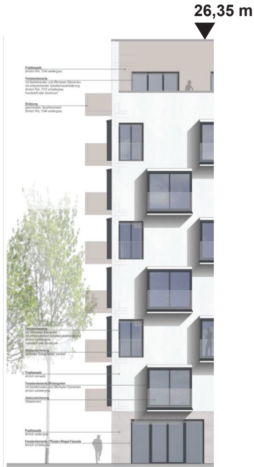
Farb- und Materialkonzept Fassade Ausschnitt Ost
