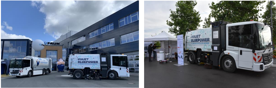
Kehrmaschine der INKB mit Brennstoffzellenantrieb ©Stadt Ingolstadt
