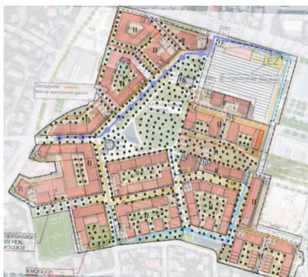
Abbildung 3: Sondenfeld Variante 2 maximale Anzahl
