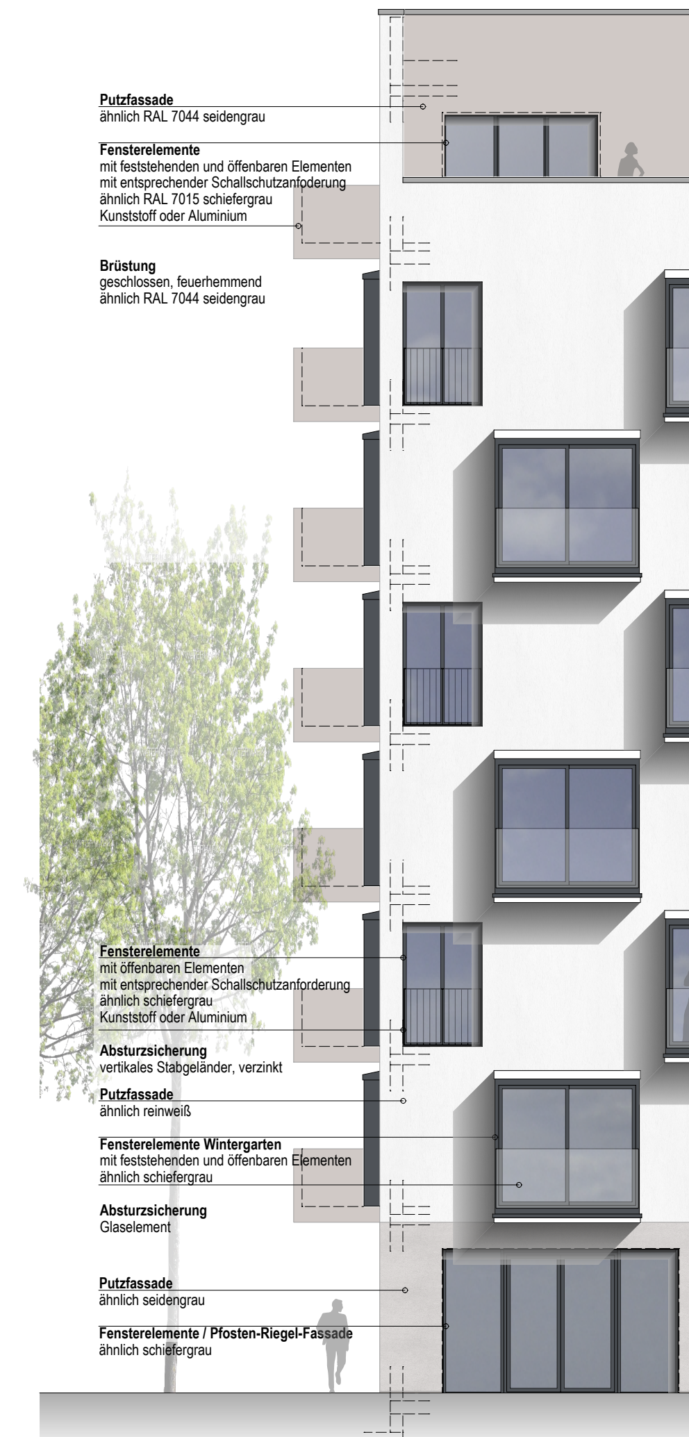
Farb- und Materialkonzept Fassade M1:100
