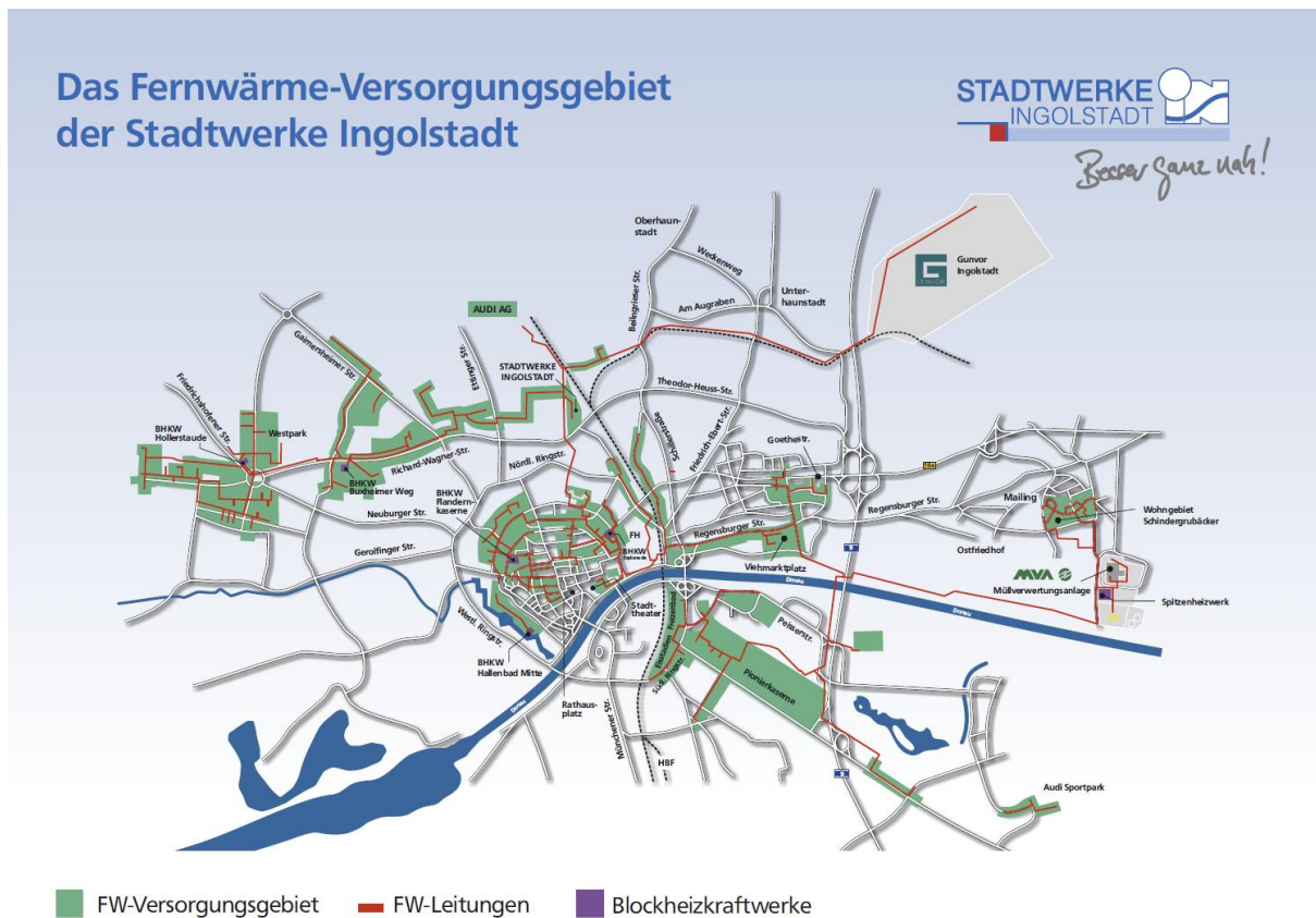
Abbildung 10: Fernwärme-Versorgungsgebiet der Stadtwerke Ingolstadt [26]
