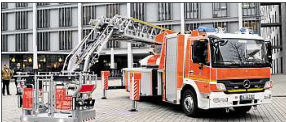
Die neue Feuerwehr-Drehleiter kann bis auf 30 Meter Höhe ausgefahren werden. Der Korb mit 500 Kilogramm Tragkraft ist abknickbar und kann so besser und präziser an Gebäude herantreiben werden. Fotos: Michel
