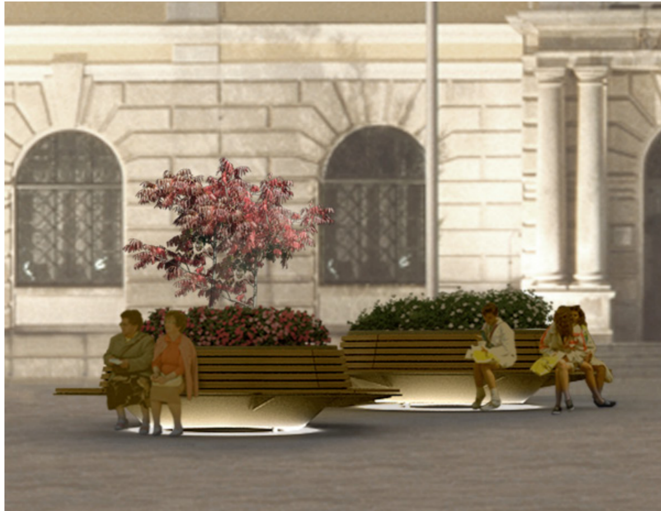
indirekte Beleuchtung über Bodenfuge mit warmweißer LED
