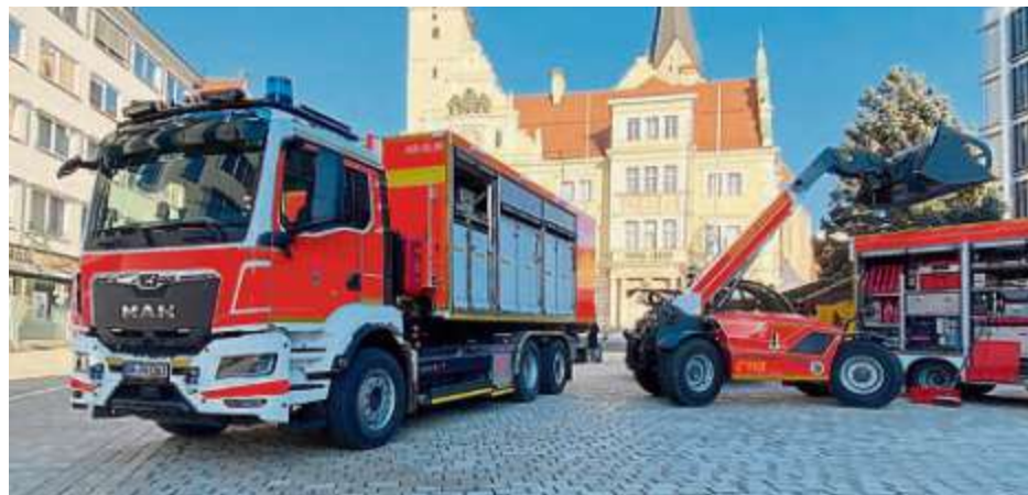
Zu den neu angeschafften Fahrzeugen gehören zwei MAN-Wechsellader, die Abrollbehälter transportieren können, sowie ein Teleskopklader, der dank Straßenzulassung auch autark zum Einsatzort fahren kann.
