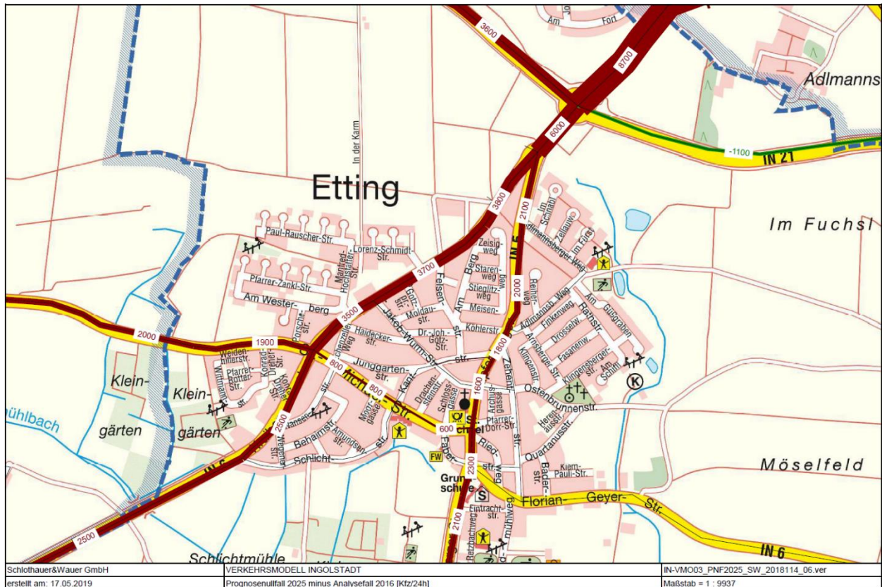
Abbildung 8: Differenzdarstellung Prognosenullfall 2025 – Analysefall 2016 [Kfz/24h] (grün = Abnahme Verkehrsmenge; rot = Zunahme Verkehrsmenge)
