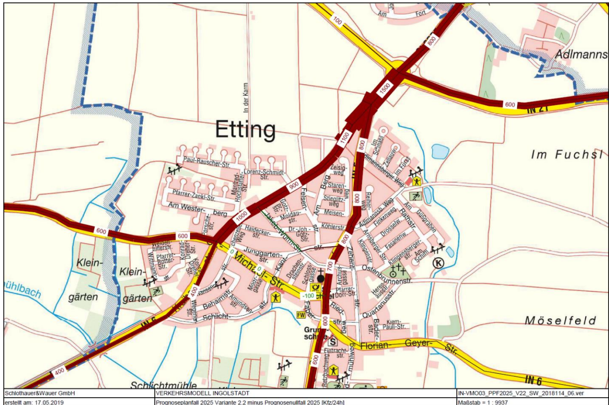
Abbildung 12: Differenz Prognoseplanfall Variante 2.2 zum Prognosenullfall 2025 [Kfz/24h] (grün = Abnahme Verkehrsmenge; rot = Zunahme Verkehrsmenge)
