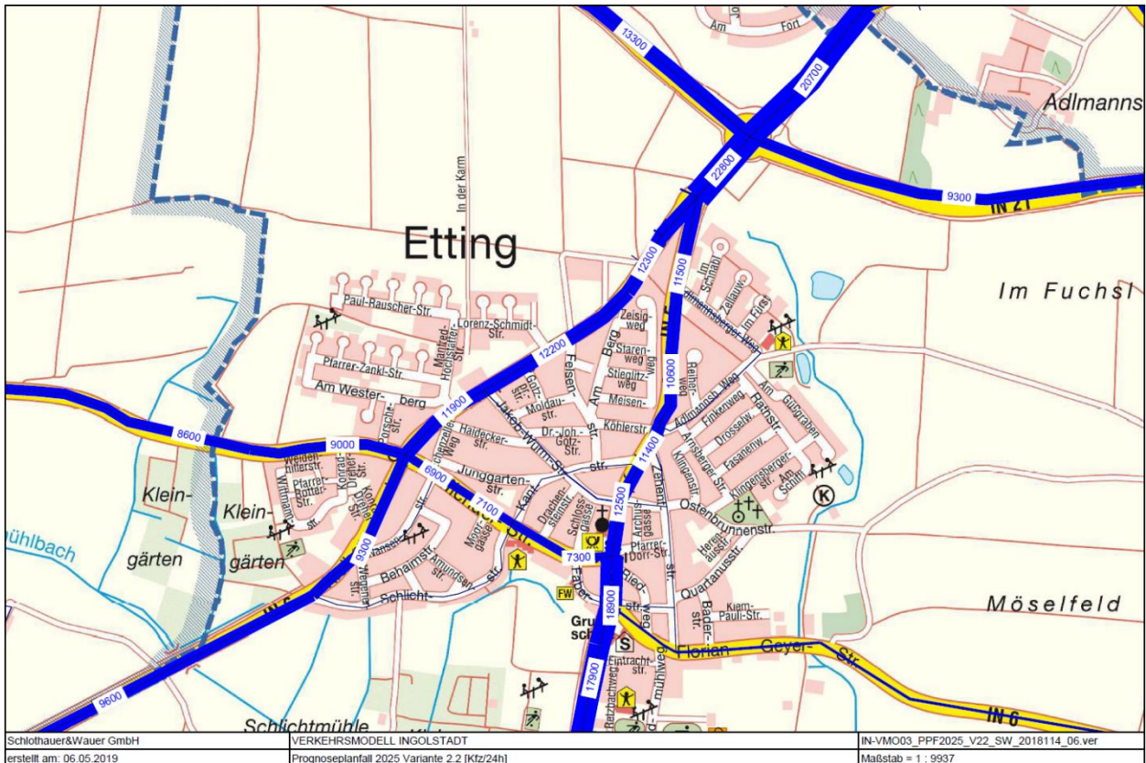
Abbildung 11: Verkehrsbelastungen Prognoseplanfall Variante 2.2 [Kfz/24h]
