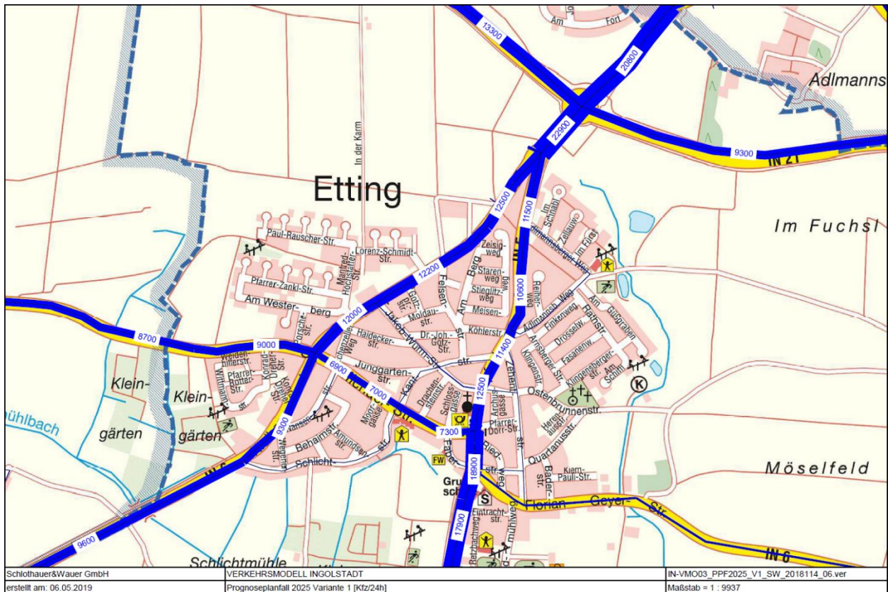
Abbildung 9: Verkehrsbelastungen Prognoseplanfall Variante 1 [Kfz/24h]
