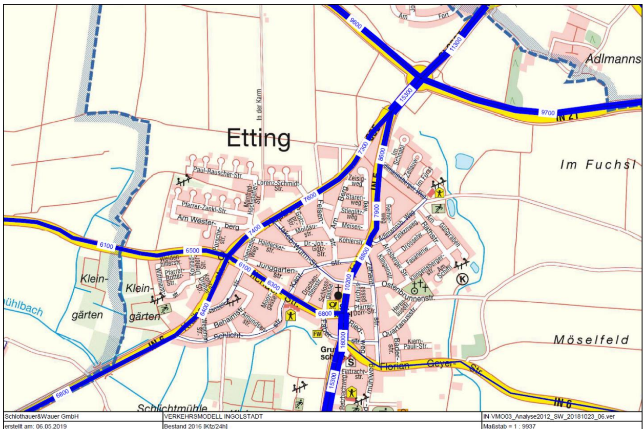
Abbildung 6: Verkehrsbelastungen Analysefall 2016 [Kfz/24h]
