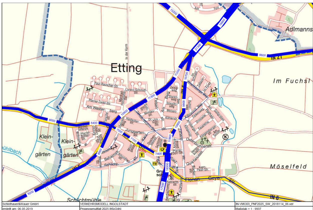
Abbildung 7: Verkehrsbelastungen Prognosenullfall 2025 [Kfz/24h]
