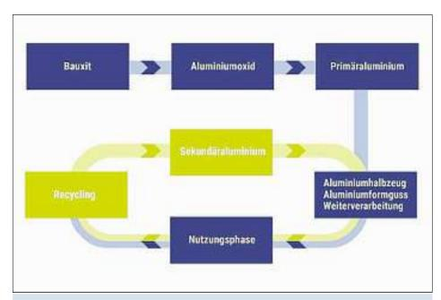
Selten und teuer: Aluminium kann per Bergbau hergestellt (blaue Linien) und anschließend durch Recycling wie in der MVA immer wieder verwendet werden (grüner Kreislauf). Quelle: GDA e.V.
