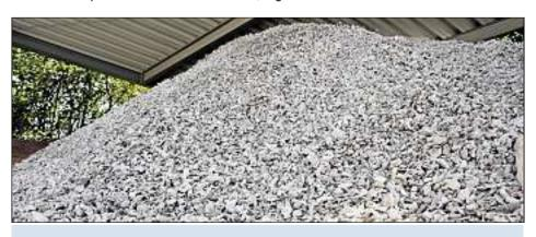
Unscheinbarer Anblick, wertvoller Inhalt: rund die Hälfte dieser Nichteisenmetalle macht Aluminium aus, das in der MVA separiert und anschließend recycelt wird.
