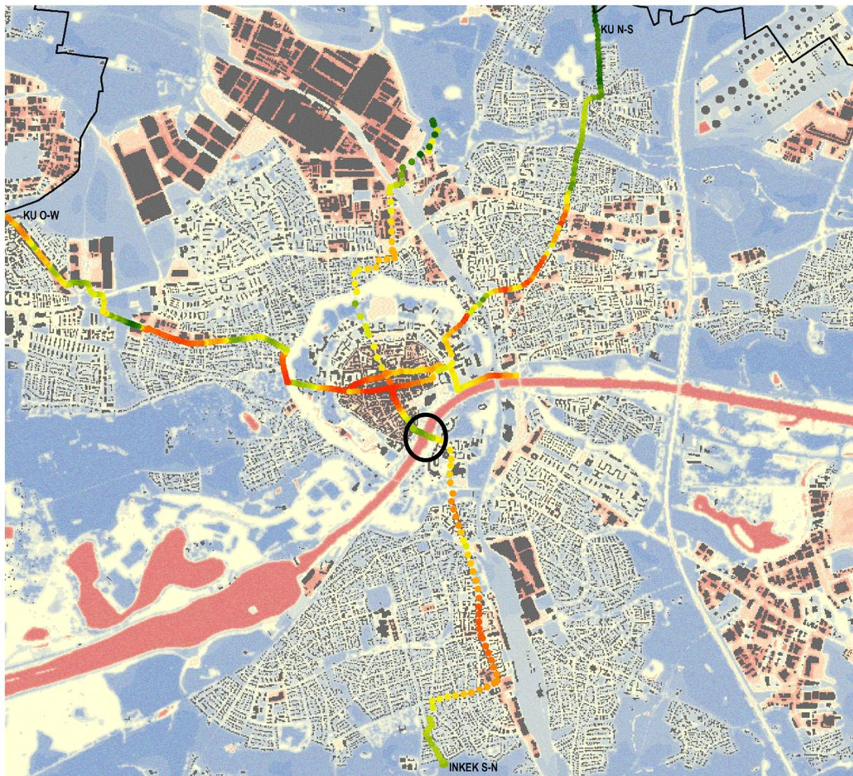
Abbildung 14: Ausschnitt der Temperaturprofile Messfahrten und der modellierten nächtlichen Lufttemperatur mit Markierung der Konrad-Adenauer-Brücke.
