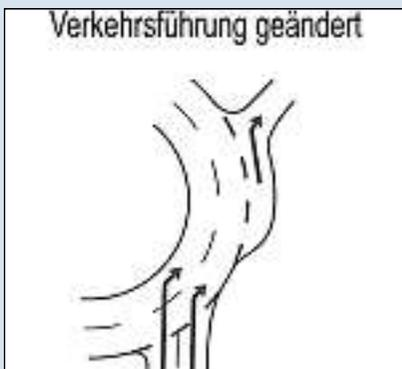
Über das Pfingstwochenende wurde der Audi-Ring saniert und umgebaut. Neu sind an jeder Ausfahrt die Ausfädelstreifen, auf denen die Geschwindigkeit zum Abbiegen reduziert werden kann, ohne den übrigen Verkehrsfluss zu behindern. Auch für ein-fahrende Fahrzeuge wird so früher erkennbar, wer weiter im Kreisverkehr fährt und wer abbiegen möchte. Diese Maßnahme soll die Verkehrssicherheit im Audi-Ring erhöhen.
